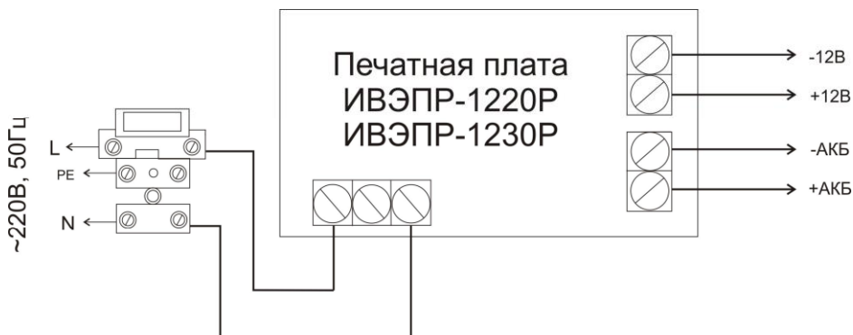
Рис. 1 Схема подключения печатной платы Минибокс с ИБП-12/3А
