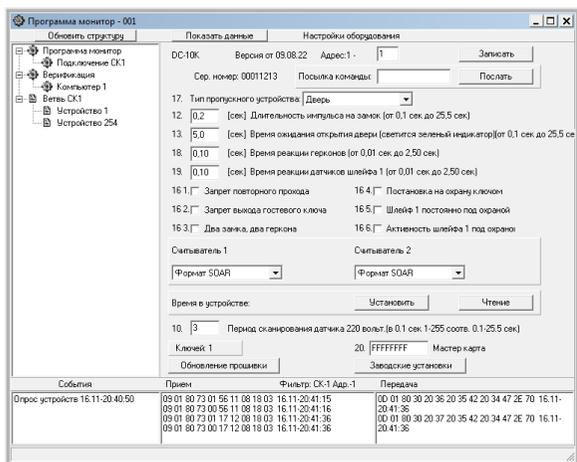
В пункте 17. задается тип пропускного устройства. После изменения этой настройки необходимо нажать кнопку запись, и интерфейс изменит настройки в соответствии с этим пунктом. Записи надо подтвердить нажатием на “YES”.
