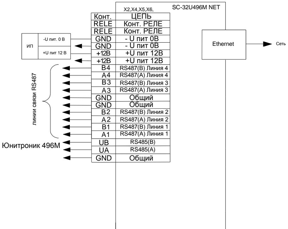
Разъём X 2, X4, X5, X6. Подключение питания и линий связи.
