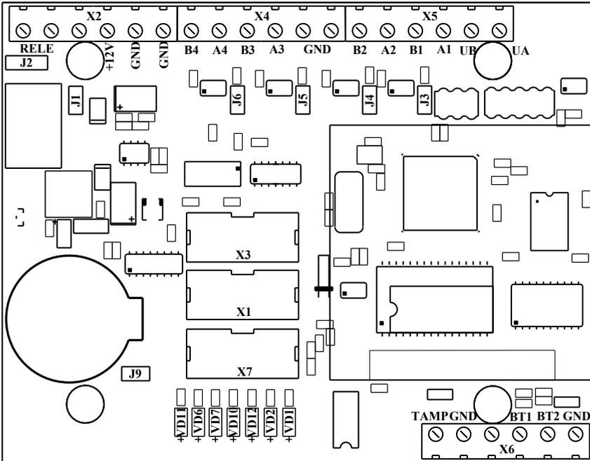
X3 - подключение модуля гальванической развязки.
