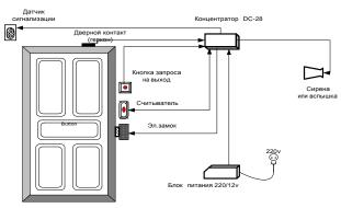
Схема построения системы доступа Рис.1
