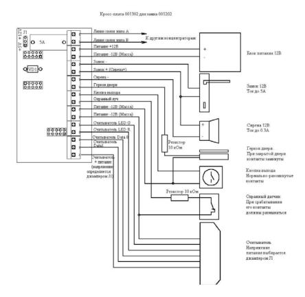
ного шлейфа и дверного геркона, при нарушении состояния датчиков по линии связи на ЭВМ управления передаётся сигнал тревоги и включает сирену.
